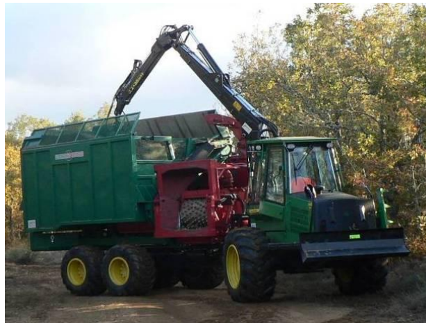
Astilladora Erjo 9/80 RC sobre autocargador Timberjack
