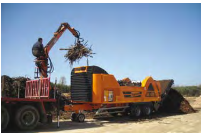
Una trituradora móvil presta servicio a los 3 CTB y también puede trasladarse para triturar en el monte y reducir los costes de transporte.
